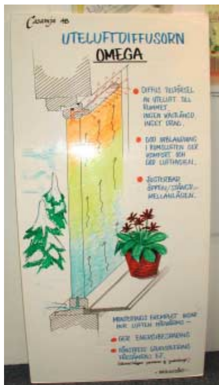
Casamjas princip för Omegaventilen
